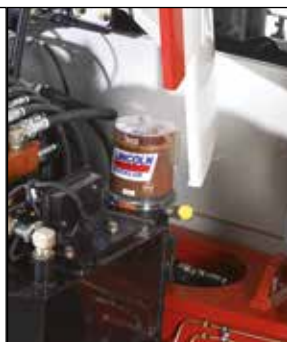
Engrase centralizado con dosificación automática y control de nivel
