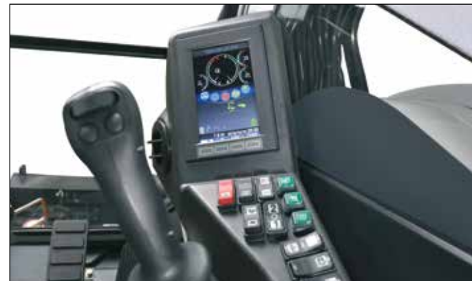
Display con elementos de control visuales y acústicos. Modo ECO de serie, con interruptor Power para aumentar la potencia.
