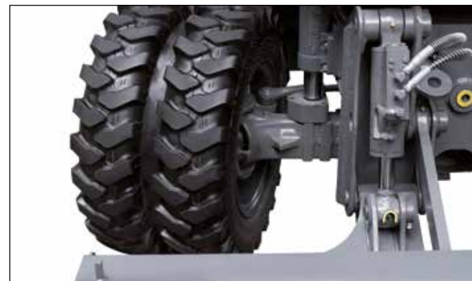
Calidad: Ejes de Dana Spicer. El eje de dirección es un eje oscilante con bloqueo automático. 8 neumáticos. Homologado para carretera.
