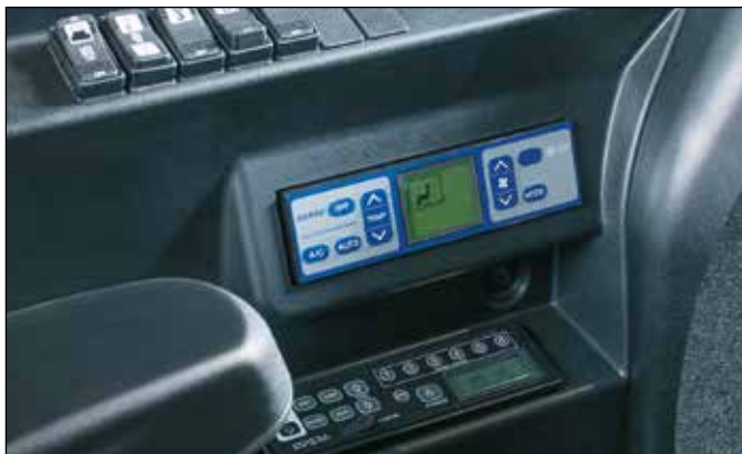
Climatronic: Aire acondicionado regulable por temperatura con modo desempañar, economy y recirculación para la seguridad y comodidad del operario.
