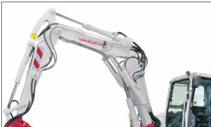
Brazo articulado con 4 circuitos auxiliares, 3 de ellos dirigidos por potenciómetros, caudal variable.
