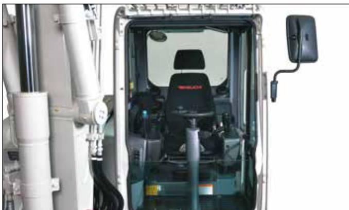
Asiento ergonómico con suspensión neumática y calefacción con elementos de mando colocados de manera óptima para trabajar sin cansancio.
