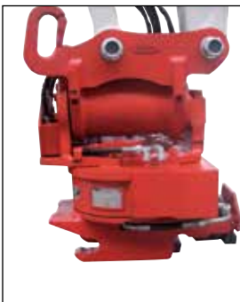
Implemento giratorio Tiltrotator con Power-tilt y enganche rápido hidráulico
