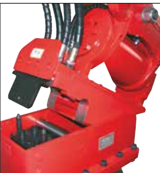
Sistema HUPPQuick: conexiones hidráulicas se conectan automáticamente durante la fase de acoplamiento
