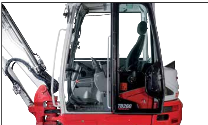
Amplia cabina insonorizada, pobre en vibraciones, compartimentos de almacenaje, entrada ancha, fijación masiva de puerta, cristal frontal abatible, aire acondicionado.
