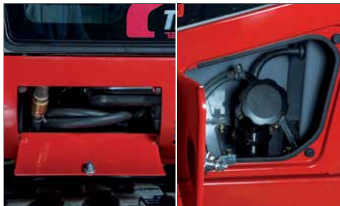
Tapa de registro adicional para un acceso óptimo a la bomba de repostar y la tapa del depósito de gasoil.
