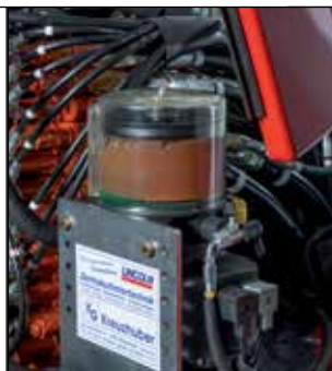
Engrase centralizado con indicador de vacío
