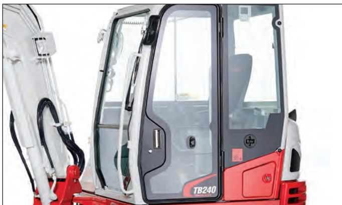
Amplia cabina insonorizada, pobre en vibraciones, con compartimentos para guardar cosas, entrada amplia con fijación masiva de puerta y cristal frontal abatible.
