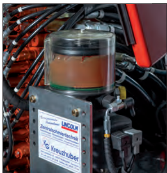
Engrase centralizado con cantidades medidas con control de nivel
