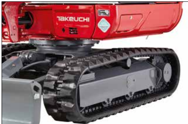
Rodillos con guía interior y exterior para un funcionamiento seguro de las cadenas de goma Double-Short-Pitch que evitan vibraciones.
