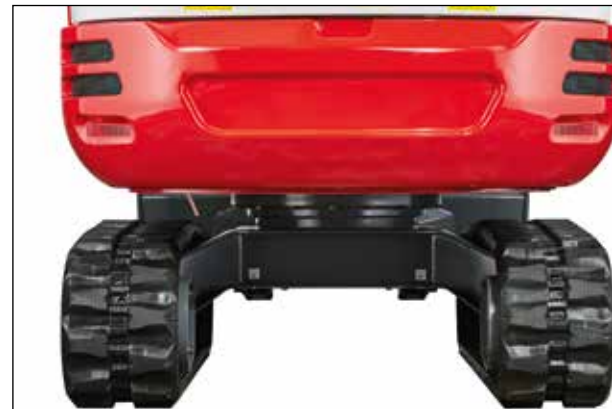
Gran distancia del eje al suelo, carter especialmente protegido.
