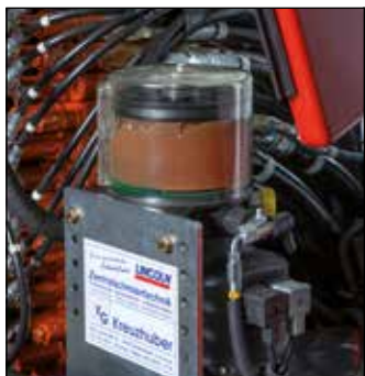
Engrase centralizado con dosificación automática y control de nivel
