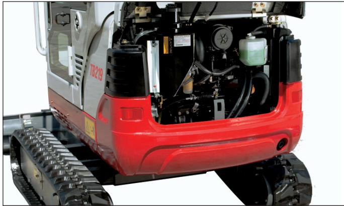
Motor con reducidos niveles de ruidos y emisiones de gas con doble filtro de aire y espacioso compartimento para el motor con contrapesos macizos lateralmente subidos
