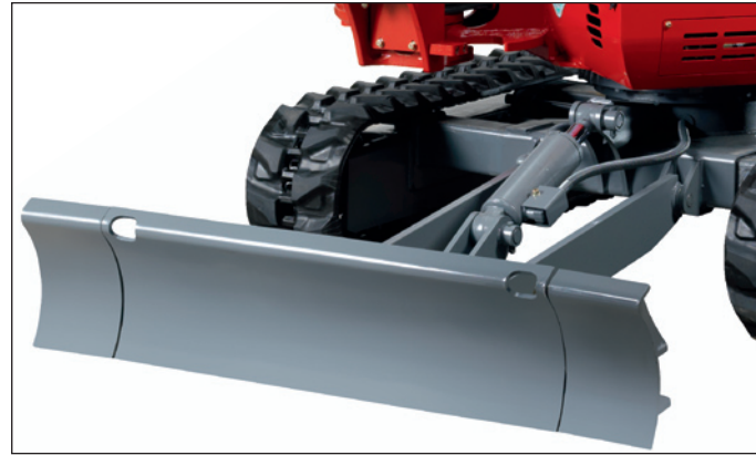
Alargada pala dozer de acero antitorsión
