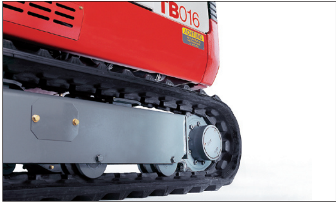
Rodillo con doble guía para un óptimo y seguro funcionamiento de las cadenas de goma Double-Short-Pitch para evitar la vibración
