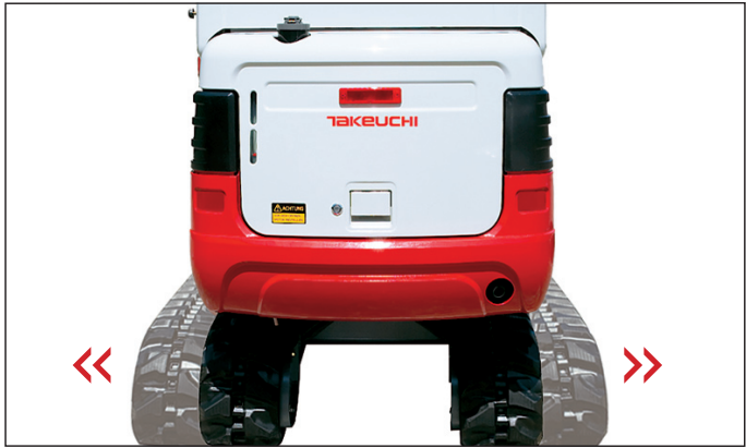
Tren de rodaje con cadenas de goma o acero, ancho de vía hidráulicamente variable
