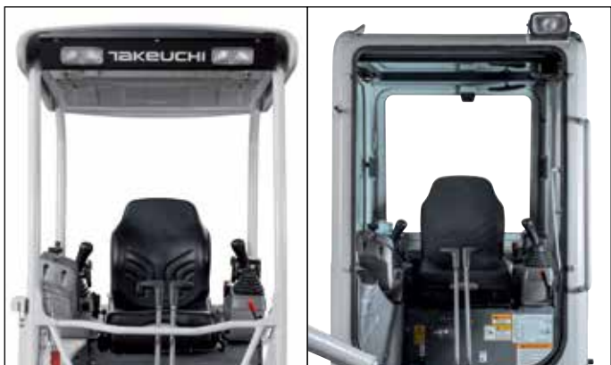
Techo de protección ROPS (ISO12117-2), TOPS (ISO12117), OPG (ISO10262 nivel 1), asiento de confort (versión: resistente a la intemperie) con cinturón de seguridad.
