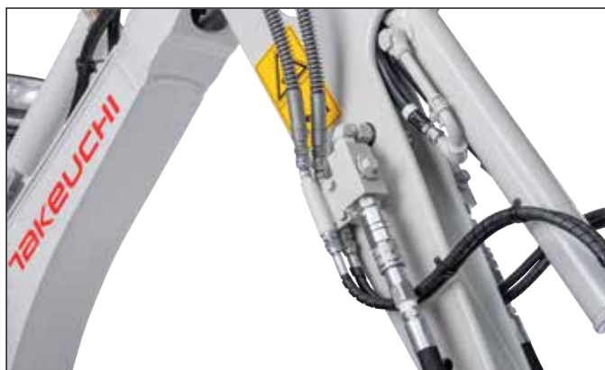
3 circuitos hidráulicos, uno de ellos dirigido por potenciómetros.
