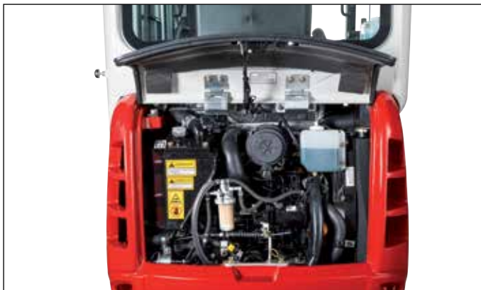
Motor con reducidos niveles de ruidos y emisiones de gases con doble filtro de aire y espacioso compartimento para el motor.
