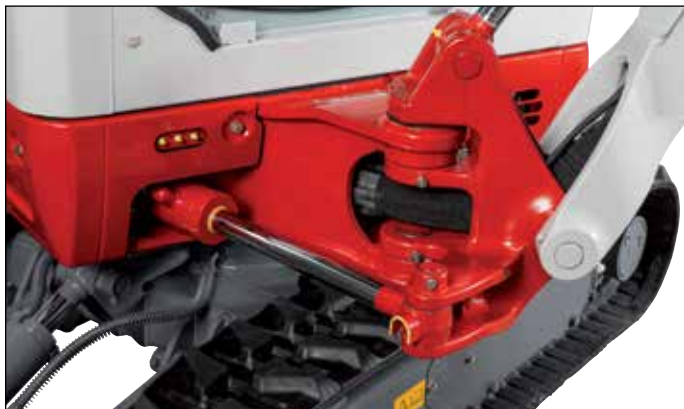
Bloque de giro del brazo robusto con latiguillos protegidos con giro hidráulico del brazo.
