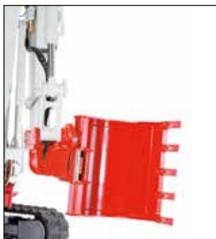
Powerlift con enganche rápido hidráulico y cazo montado al revés
