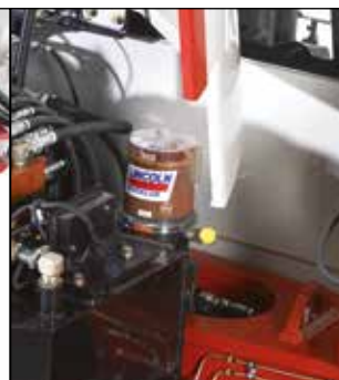
Engrase centralizado con dosificación automática con indicador de nivel
