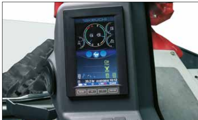
Display multifuncional, con visualización de la cámara de marcha atrás.
